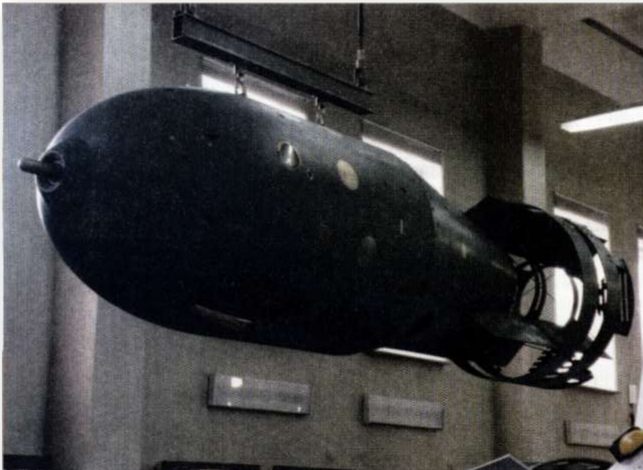
Первая тактическая бомба с зарядом РДС-4. Разработка КБ-11 (1953 г.), находилась на вооружении с 1954 г. по 1965 г.
